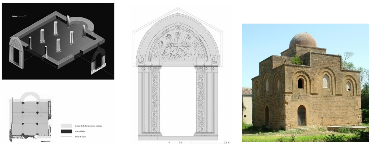
Figura 8. Planimetria della Cappella di San Michele con ipotesi ricostruttiva del portale principale e ricollocazione di entrambi i portali; Chiesa della SS. Trinità di Delia a Castelvetrano (TP)
